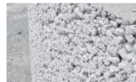
粗骨材とセメントで作られるポーラスコンクリート2次製品の表面には無数の空隙が生じ、そこから周囲の土中に雨水が浸透していく
