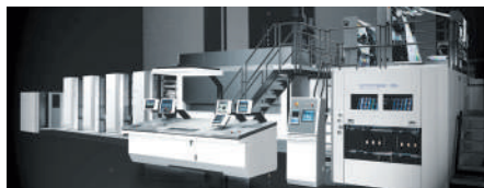
同社が所有するオフセット輪転機。1分間に800枚分印刷ができる
