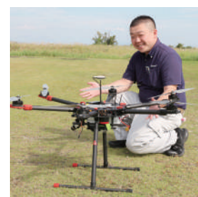
導入したロープ延線用のドローン
